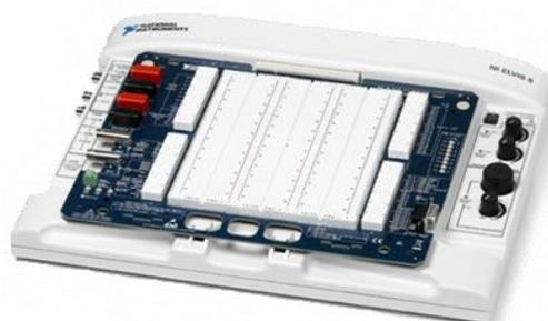
*Рис. 1. Виртуальный стенд ELVIS*
